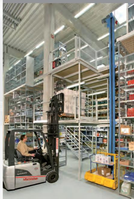
*L'installation de rayonnage à tablettes à trois étages de type META CLIP® est une installation à étages avec une capacité d'env. 10 000 articles*
