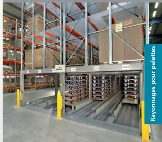
Sous les systèmes de rayonnages est situé l'installation de convoyage pour le transporteur MultiVario fetra
