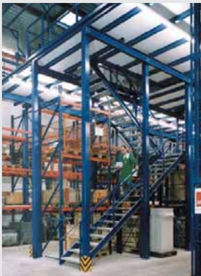
Palettenregalanlage mit Stahlbaubühne überbaut
