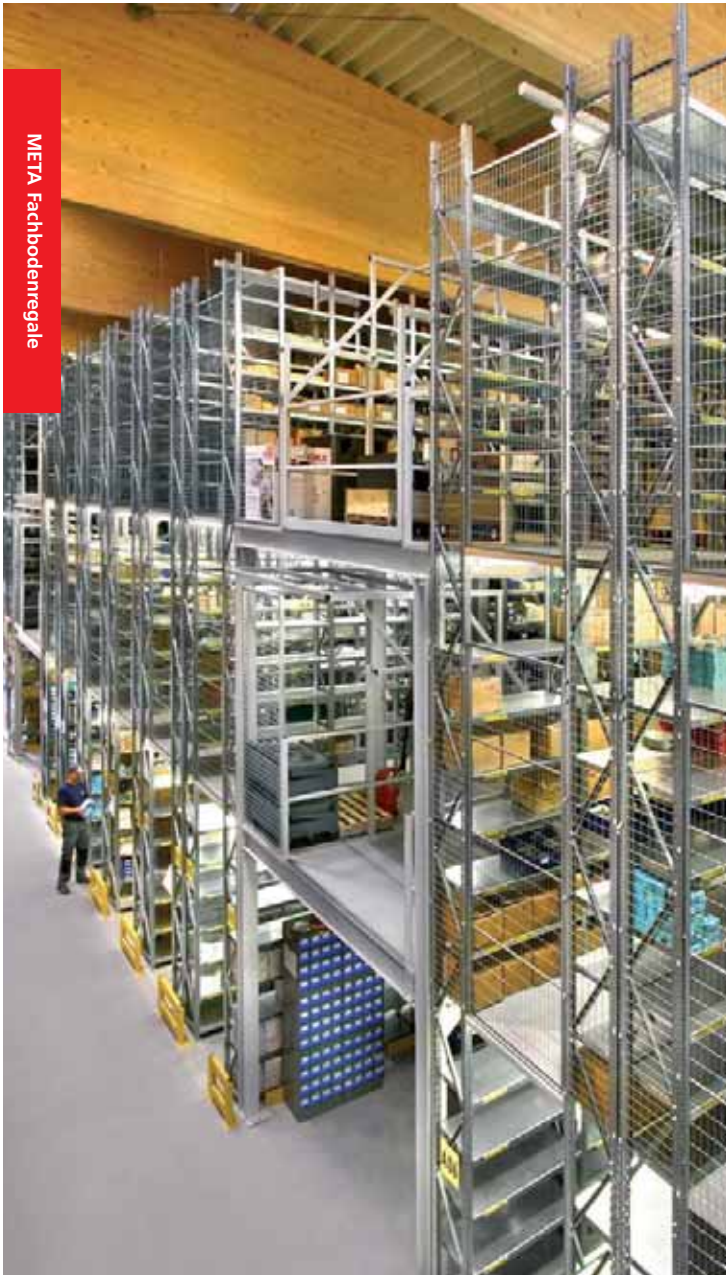
linkes Bild: META HIGH-CLIP® Fachboden-Geschossanlage rechtes Bild: META HIGH-CLIP® Fachboden-Hochregal
